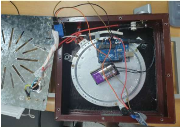
그림 1. 하이라이트와 릴레이와 일산화탄소측정센서 연결된 내부 모습.
